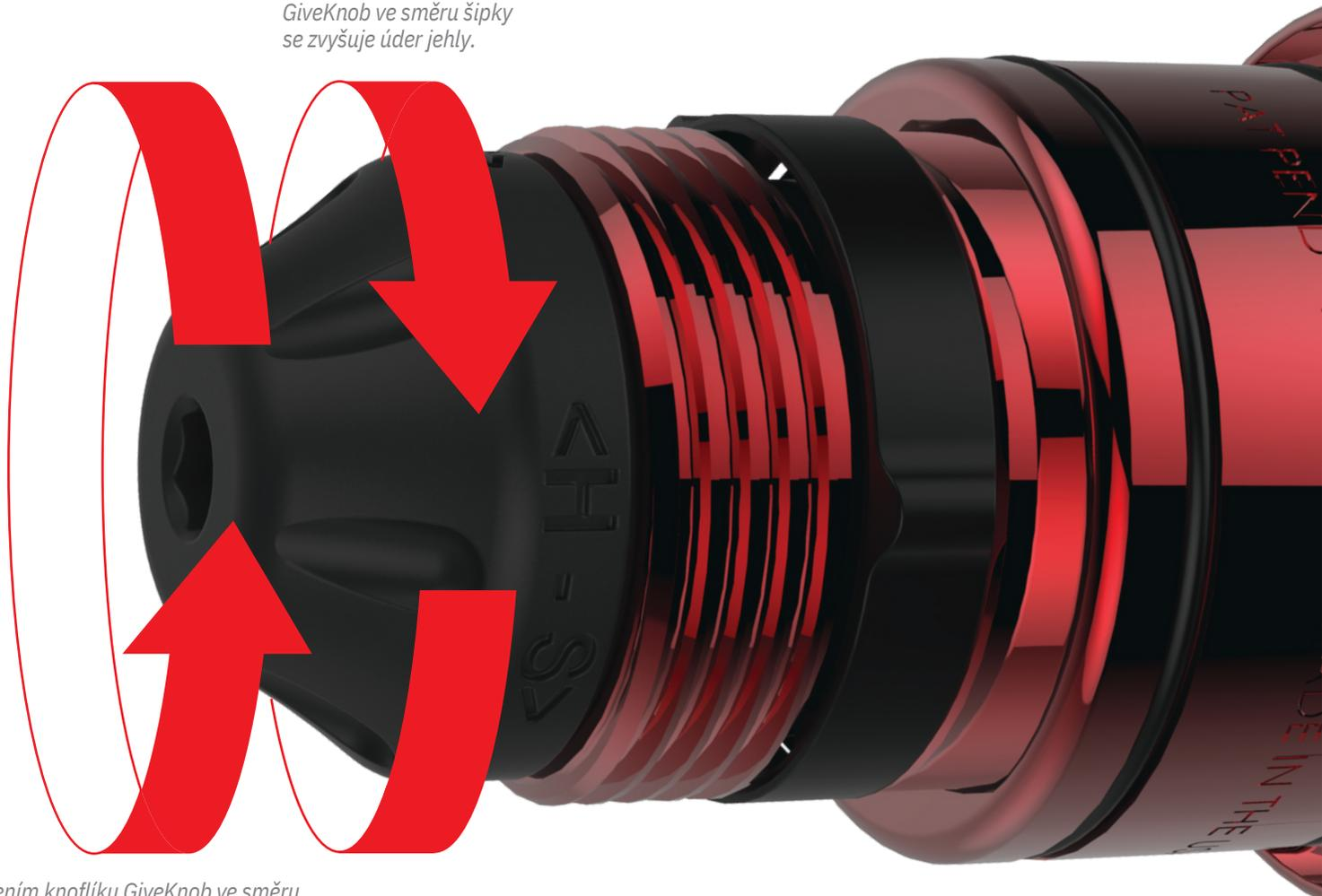
*Otáčením knoflíku GiveKnob ve směru šipky snížíte hodnotu úderu jehly nebo ji zcela zablokujete. Vždy se vraťte o jedno kliknutí zpět od maximálního nastavení.*
